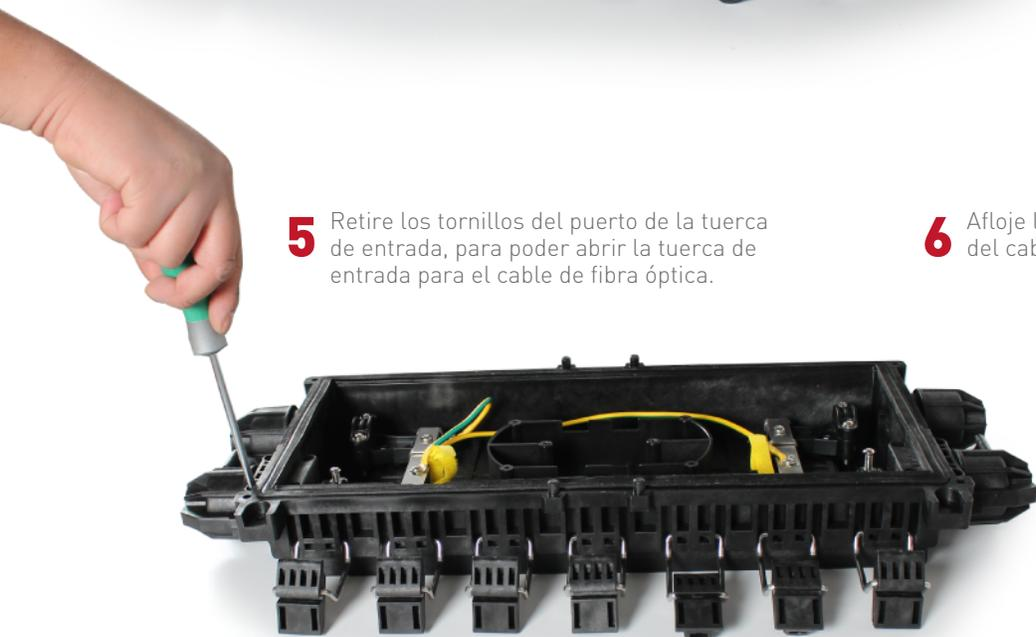
**5** Retire los tornillos del puerto de la tuerca de entrada, para poder abrir la tuerca de entrada para el cable de fibra óptica.
