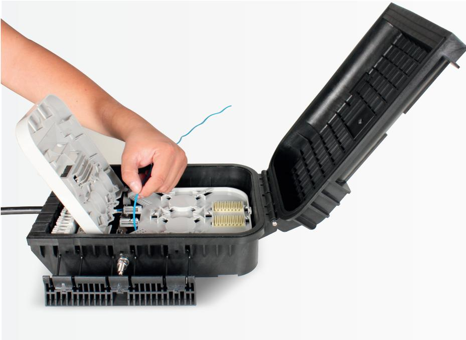
**PASO 3. Enrutamiento del cable de fibra óptica** sin protección en la charola de empalme.
