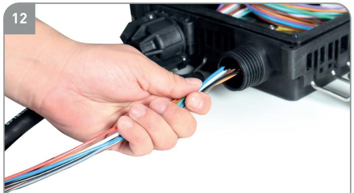
Introducir los cables de fibra óptica en los puertos de derivación. Y fijar el miembro central de fuerza en la base del cierre de empalme y el cable con la mordaza plástica.
