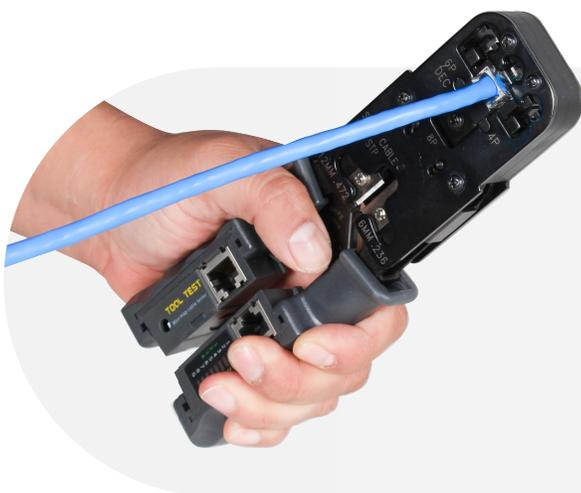
**PASO 5:** Una vez que haya crimpado el plug, **proceda a revisar ambos extremos** para validar su continuidad y que estén correctamente instalados.
