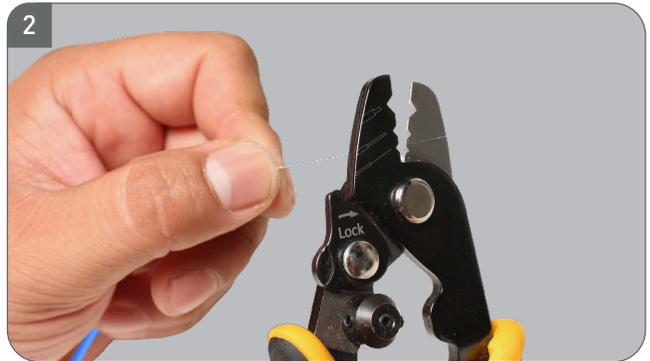
Retirar todas las cubiertas del cable, hasta llegar al revestimiento o Cladding.
