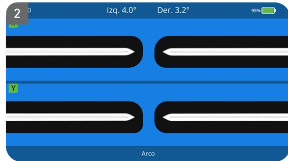
Este proceso se repetirá tantas veces como sea necesario para ajustar adecuadamente los parámetros de empalme. Con cada ciclo, la fibra se deformará progresivamente hasta alcanzar el ajuste óptimo.
