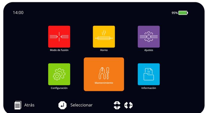
Incluye la configuración del arco, el análisis de los motores y los electrodos, así como el diagnóstico de hardware, descritos a continuación.
