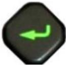
**Botón de limpieza:** Presionar este botón para producir una descarga breve entre los dos electrodos de la empalmadora, eliminando el polvo flotante y el alcohol en la fibra óptica. Sin embargo, las rebabas en la cara del extremo de la fibra óptica no se pueden eliminar.
