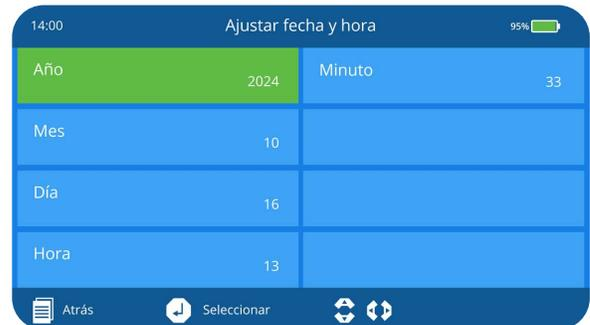
**Nota:** La batería de respaldo para alimentar el reloj del sistema de la empalmadora asegura que la fecha y la hora ajustadas se guarden, sin cambiarse al apagar el equipo, o que este se quede sin batería.
