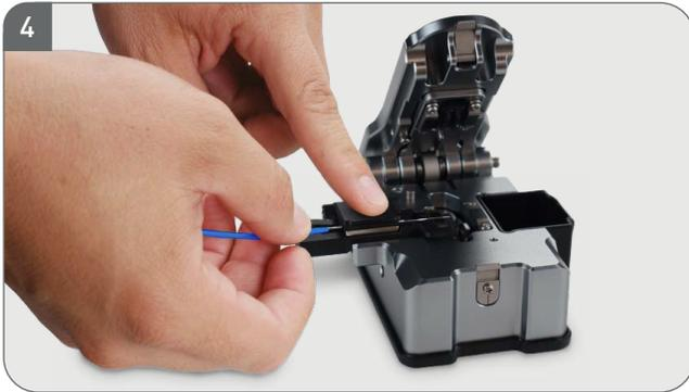
Cortar la fibra a una longitud de 10 mm utilizando la cortadora de precisión OPHECOPAUP20P Optronics®.
