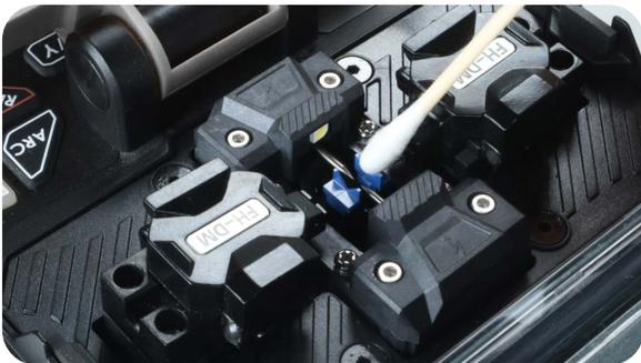
3 Limpiar la ranura en forma de V (V-Groove) con un hisopo de algodón humedecido en alcohol isopropílico.
