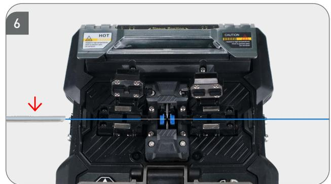
Colocar la segunda fibra óptica, previamente cortada, en la otra zona de fusión, asegurando que quede asentada en la ranura en V. Evitar que la punta de la fibra sobrepase la altura de los electrodos y tener cuidado de no golpear ni ensuciar la fibra.
