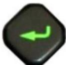
**Ingresar:** Presionar este botón para acceder al menú del siguiente nivel; cambiar el movimiento de la fibra óptica hacia la izquierda y derecha durante el ajuste del motor en el menú de prueba; usar para confirmar el inicio de la prueba.
