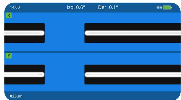
De acuerdo con la cantidad de acercamiento calculada, la empalmadora determina automáticamente si esta es adecuada. Si la cantidad de acercamiento no es correcta, la empalmadora ajustará automáticamente el valor del parámetro de acercamiento y luego repetirá los pasos a, b y c, hasta que la cantidad se corrija con éxito.
