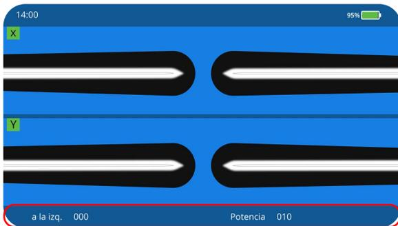
El mensaje mostrado en la parte inferior, a la izquierda, indica si la posición del arco está desalineada hacia la derecha o hacia la izquierda. Si la posición se encuentra entre 000 y 003, no es necesario realizar ajustes. Por otro lado, en la parte derecha se muestra la potencia del arco eléctrico; es ideal que esta potencia esté entre 008 y 012.
