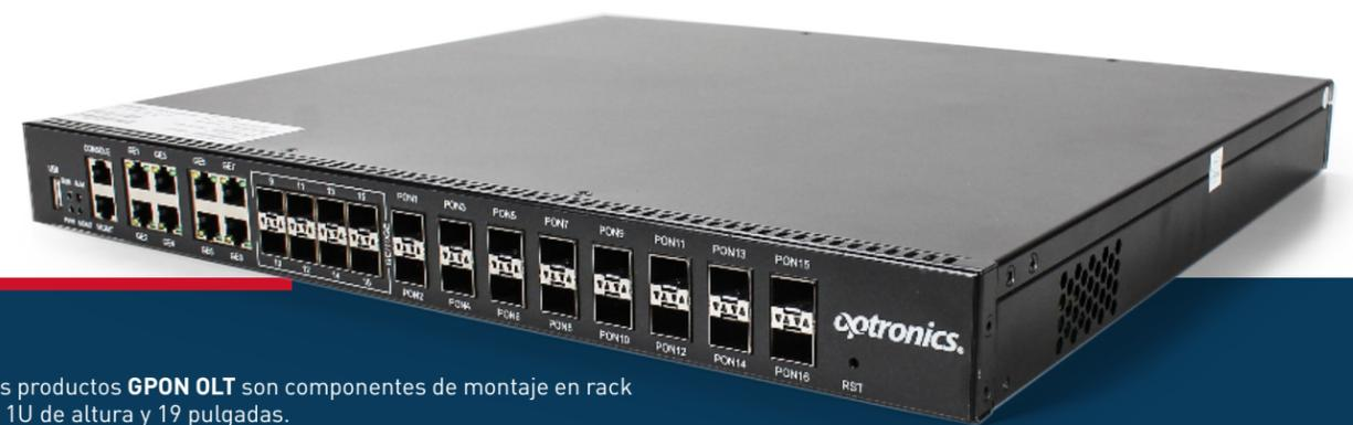
Los productos **GPON OLT** son componentes de montaje en rack de 1U de altura y 19 pulgadas.
